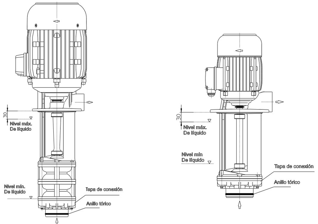
Las bombas TAS/STS/TES/SES son bombas centrífugas con rodetes semiabiertos y un rodete axial. Su construcción es idéntica a la de las bombas TAL/SAL/TL/STL, solo que en las TAS/STS/TES/SES la tapa de aspiración se sustituye por una tapa de conexión con un anillo tórico (v. imagen).
