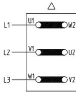
**Conexión en triángulo**
