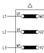
**Conexión en triángulo**
