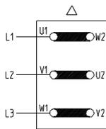
**Conexión en triángulo**
