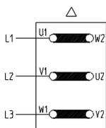
**Conexión en triángulo**
