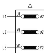
**Conexión en triángulo**
