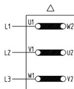
**Conexión en triángulo**
