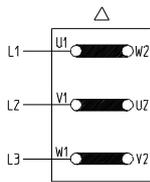
**Conexión en triángulo**
